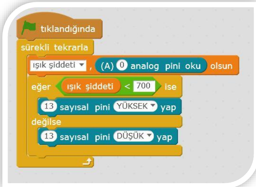
mBlock Kodu 6: LDR ile Karanlıkta Yanan, Aydınlıkta Sönen Led Uygulaması
